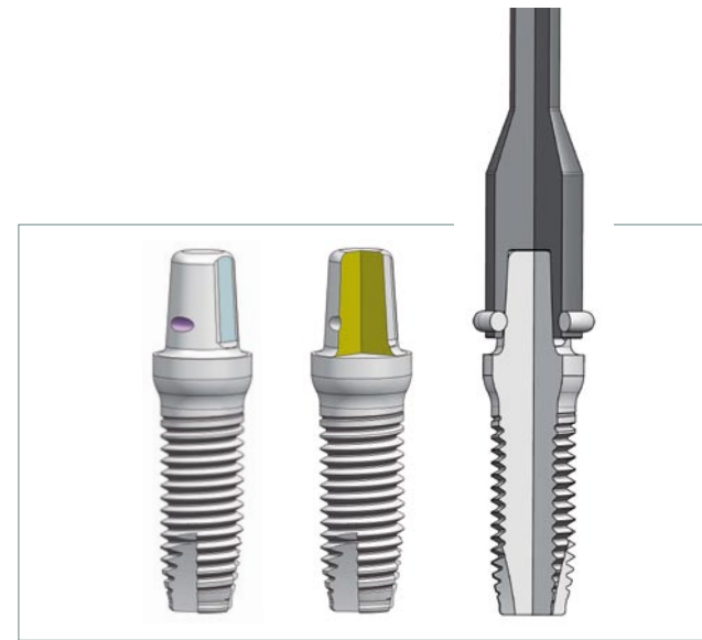
Implant Z-Look3 Evo / Vue en coupe du pilier / Vue en coupe du pilier avec l'adaptateur de contre-angle
